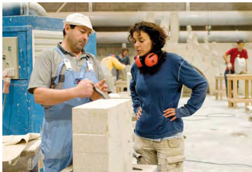
Na Escola de Canteiros de Pontevedra ensínase todo o proceso a partir de grandes bloques de granito, cos que o alumno se ten que enfrontar sen axuda de maquinaria.
